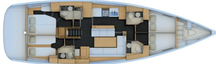
**Version 5 cabines :** Deux cabines modulable à l'avant, cabine VIP et cabine invités à l'arrière, cabine latérale (illustration avec cabine skipper optionnelle)
